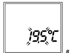
Symbol  $\wedge$  oder  $\vee$  kurz auf dem Bildschirm angezeigt. Die Temperatur kann zwischen 5,0 und 35,0 °C eingestellt werden.
