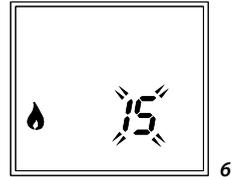
Die Flammenhöhe kann zwischen 1 und 15 eingestellt werden. Die Höhe der Flamme wird auf dem Bildschirm angezeigt: 1 (niedrigster Stand) und 15 (höchster Stand).
