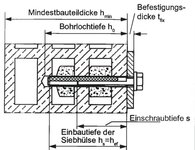
c) Einbau mit Ankerstange UVT Top A und Siebhülse UVT Top H 18x130/200 bzw. UVT Top H 22x130/200
