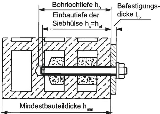
b) Einbau mit Innengewindehülse UVT Top E und Siebhülse UVT Top H
