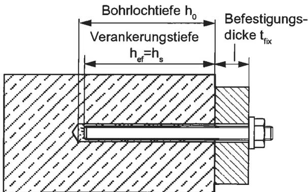
e) Dübel im eingebauten Zustand in Porenbeton mit Ankerstange UVT Top A und UVT Zentrierhülse PBZ
