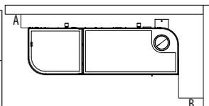
Wenn der Fußboden aus brennbarem Material ist, empfehlen wir, einen Schutz aus nicht brennbarem Material zu verwenden (Stahl, Glas, ...), der auch den frontalen Teil vor einem eventuellen Herabfallen von Brennstoff während der Reinigungsoperationen schützt.
