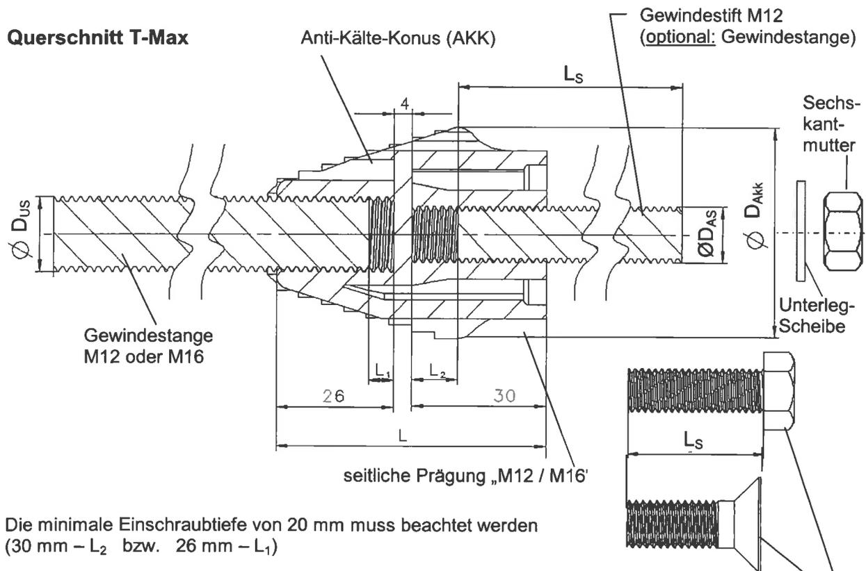
Die minimale Einschraubtiefe von 20 mm muss beachtet werden (30 mm – L<sub>2</sub> bzw. 26 mm – L<sub>1</sub>)
