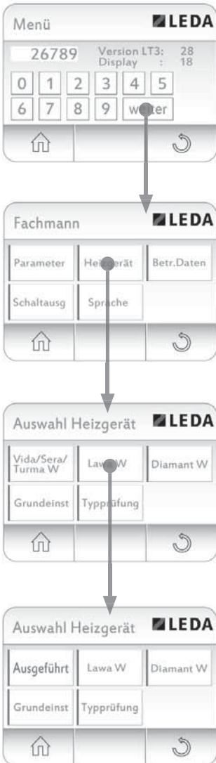
Abb. 4.13 Zugriff auf die Heizgeräte-Ebene
