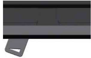
Abb. 6.5 Verbrennungsluftschieber: ganz links - ganz geschlossen
