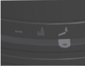
Abb. 4.7 Verbrennungsluftschieber: ganz rechts - Luft ganz geöffnet
