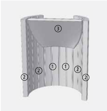
Abb. 5.3 Feuerraumauskleidung NOVIA W
