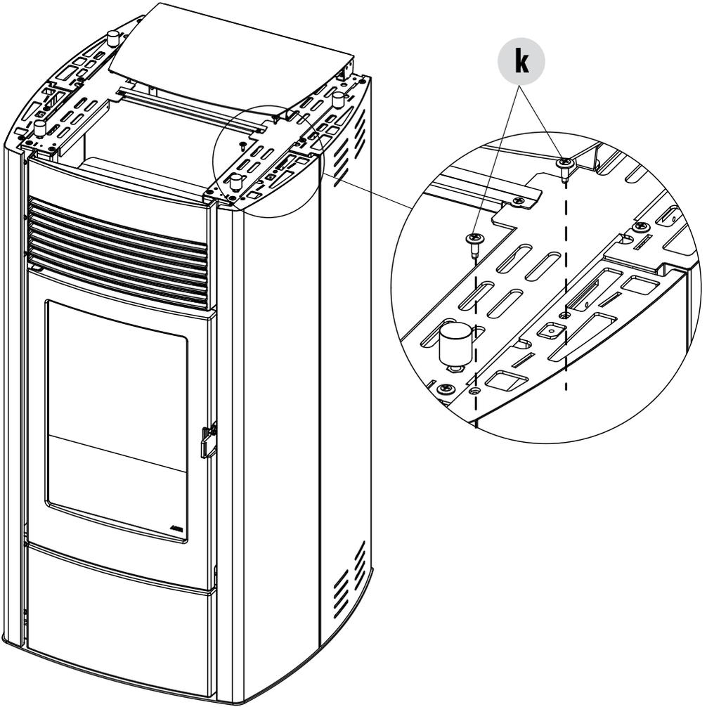
Nach erfolgter Montage der Metallplatten, die Topplatte „F“ wieder auf den entsprechenden verstellbaren Gummipuffern, die sich an der Struktur des Ofens befinden, auflegen.
