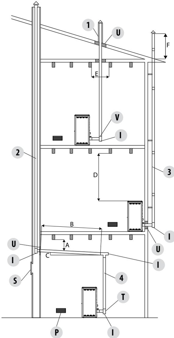
1. Installation von einem Schornstein  $\varnothing 120\text{mm}$  mit einer vergrößerten Bohrung für den Durchgang des Rohrs von: mindestens 100 mm um das Rohr, wenn es mit nicht brennbaren Teilen wie Zement, Ziegel usw. zusammentrifft; oder mindestens 300mm um das Rohr herum (bzw. siehe Daten auf dem Schild), wenn es mit brennbaren Teilen wie Holz usw. verbunden wird.
