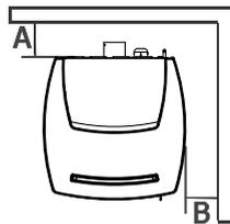
Wenn der Fußboden aus brennbarem Material ist, empfehlen wir, einen Schutz aus nicht brennbarem Material zu verwenden (Stahl, Glas, ...), der auch den frontalen Teil vor einem eventuellen Herabfallen von Brennstoff während der Reinigungsoperationen schützt.
