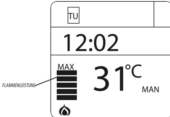
Ist die Belüftung auf die Betriebsart MANUELL eingestellt, so wird eine Funktion aktiviert, die die maximale Leistung des Ofens auf Grundlage der Belüftung begrenzt.
