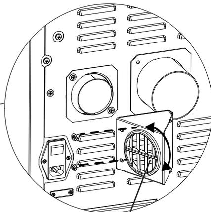
GITTER MIT SCHWENKBAREN LAMELLEN
