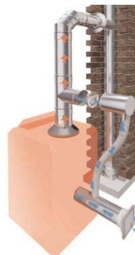
*Darstellung einer Feuerstätte für den raumluftunabhängigen Betrieb*
