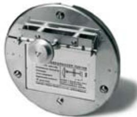
**Präzisions-Zugbegrenzer Typenreihe UNIVERSAL Z 130, ZUK 130, Z 180 und ZUK 180** Zugbegrenzer mit Motorsteuerung (nachrüstbar) zur kombinierten Nebenluftvorrichtung. Regelscheibe und Gehäuse komplett aus Edelstahl, Einstellgewichte Messing, außenliegende selbstreinigende Lager, mit Arretierungsmöglichkeit in der Geschlossenstellung, zur Schornstein-Montage mit dem KW-Rohrfutter oder Abgasrohr-Montage mit dem KW-Anschlussstück. Typenreihe ZUK mit fest eingestellter Überdruckklappe.
