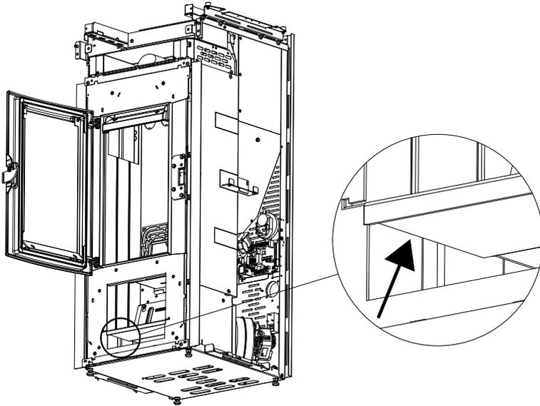
Mit einer starren Stange oder einer Flaschenbürste die Wände des Feuerraums (siehe Pfeile - jeweils rechts und links des Feuerraums) an den soeben entfernten Platten "S" abkratzen, sodass die Asche in das Fach darunter fällt.
