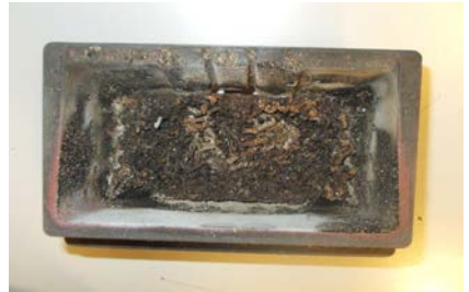
BEISPIEL VERSCHMUTZTE BRENNSCHALE
