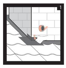
Fixieren Sie die Eckenabdichtung vorerst, z.B. mit einem Streifen Tesafilm, an dem abzudichtenden Bauteil.
