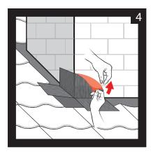
Entfernen Sie die Schutzfolie des obenliegenden Klebekragens auf der rechten Seite und drücken Sie den Klebekragen ebenfalls an das Bauteil.
