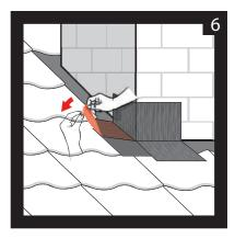
Entfernen Sie die Schutzfolie auf der linken Seite und kleben Sie die Fläche gerade auf die saubere und fettfreie Oberfläche.
