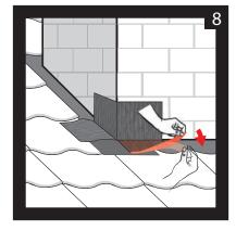
Entfernen Sie die Schutzfolie auf der rechten Seite und kleben Sie die Fläche gerade auf die saubere und fettfreie Oberfläche.
