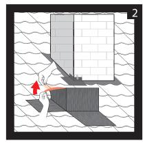
Entfernen Sie die Schutzfolie des obenliegenden Klebekragens auf der linken Seite.
