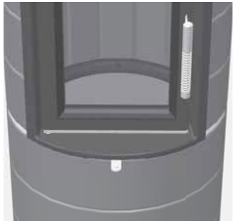
Abb. 4.8 Verbrennungsluft-Schieber, in der Mitte, Betrieb bei Nennwärmeleistung
