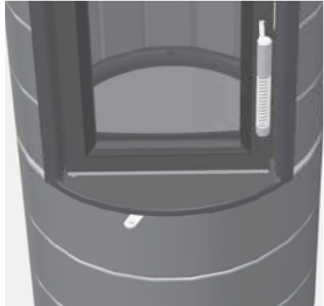
Abb. 4.7 Verbrennungsluft-Schieber, links, ganz geschlossen
