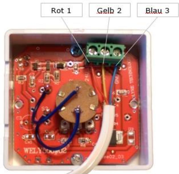
Das weiße Kontrollkabel wird in dem vorgesehenen Kabelschlitz platziert, bevor die Rückseite des Geschwindigkeitsregulators wieder befestigt wird. Danach kann der Geschwindigkeitsregulator mit doppelseitigem Klebeband oder Schrauben an der Wand befestigt werden.
