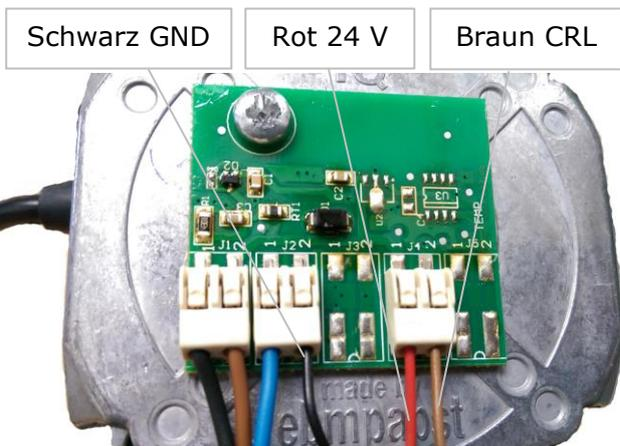
ca. 5 cm ab. Danach sollten Sie bei jedem Kabel ca. 5mm an jedem Ende abisolieren. Das Metall der Kabel wird ein paar Mal gedreht, sodass die gedrehten Enden spitz und gleichmäßig werden. Die Kabel werden in den Anschlussklemmen befestigt, indem die Halter / Verschlüsse der Anschlussklemmen gedrückt werden und gleichzeitig die Enden der Kabel in die Anschlussklemme eingeführt werden (siehe Grafik).
