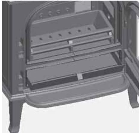
Abb. 4.14 Entnehmen des Aschekastens
