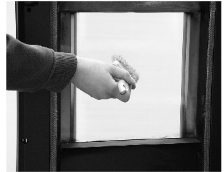
Reinigung der Glasscheibe
