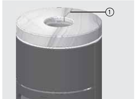
Abb. 3.22 Natursteindeckplatte mit Dehnungsspalt
