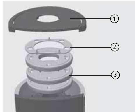
Abb. 3.2 Guss Speichereinlagen demontieren
