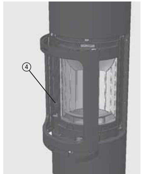
Abb. 3.6 NOVIA: Spannschraube der Türfeder
