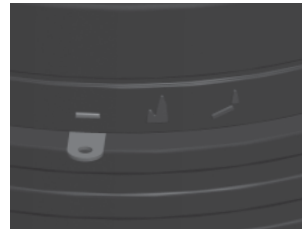
Abb. 4.15 Verbrennungsluftschieber: ganz links - ganz geschlossen
