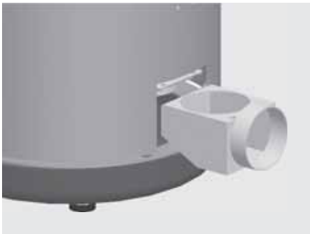
Abb. 3.13 FORMIA, NOVIA A und NOVIA C: Anschlusskasten einschieben
