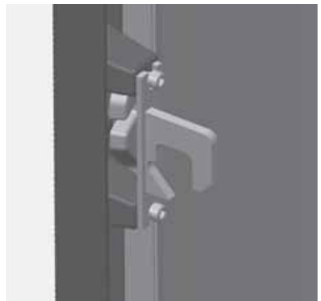
Abb. 4.43 Verschlussriegel in der Tür des DELTA plus
