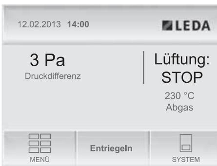
Abb. 7.4 Anzeige bei einer Störung
