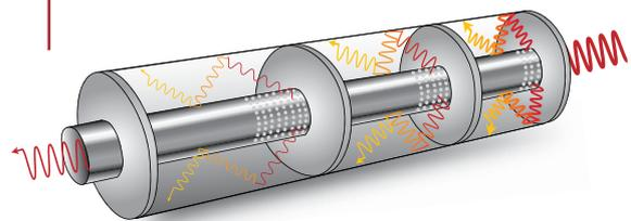
Jede der Kammern des Tiefton-Schalldämpfers filtert einen bestimmten Frequenzbereich. Durch das Auslegungsprogramm werden dabei die Maße des Schalldämpfers berechnet.
